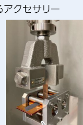
めっき引き剥がし 試験片保持具
